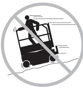
根据地面状况、拥塞程度、坡度、人员位置和可能引起碰撞的任何其它因素，限制行进速度。
