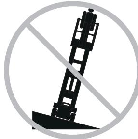
不要把倾斜警报当成水平指示器。只有机器处于斜坡上，底座上的倾斜警报器才会鸣响。
