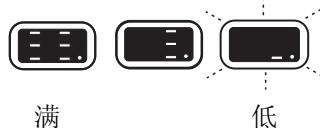
使用 LED 诊断读数装置确定蓄电池电平。
